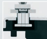
Achtkant-Sicherheitsverschlussbolzen im Sicherheitsschließblech fest verankert.
