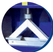
Prüfung der Eckenfestigkeit der Schweißnaht
