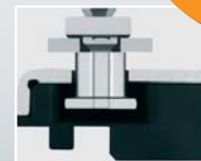
Achtkant-Sicherheitsverschlussbolzen im Sicherheitsschließblech fest verankert
